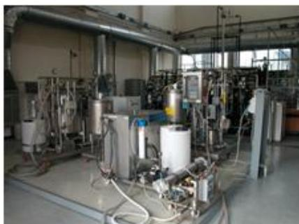
Impianto di filtrazione a membrana
